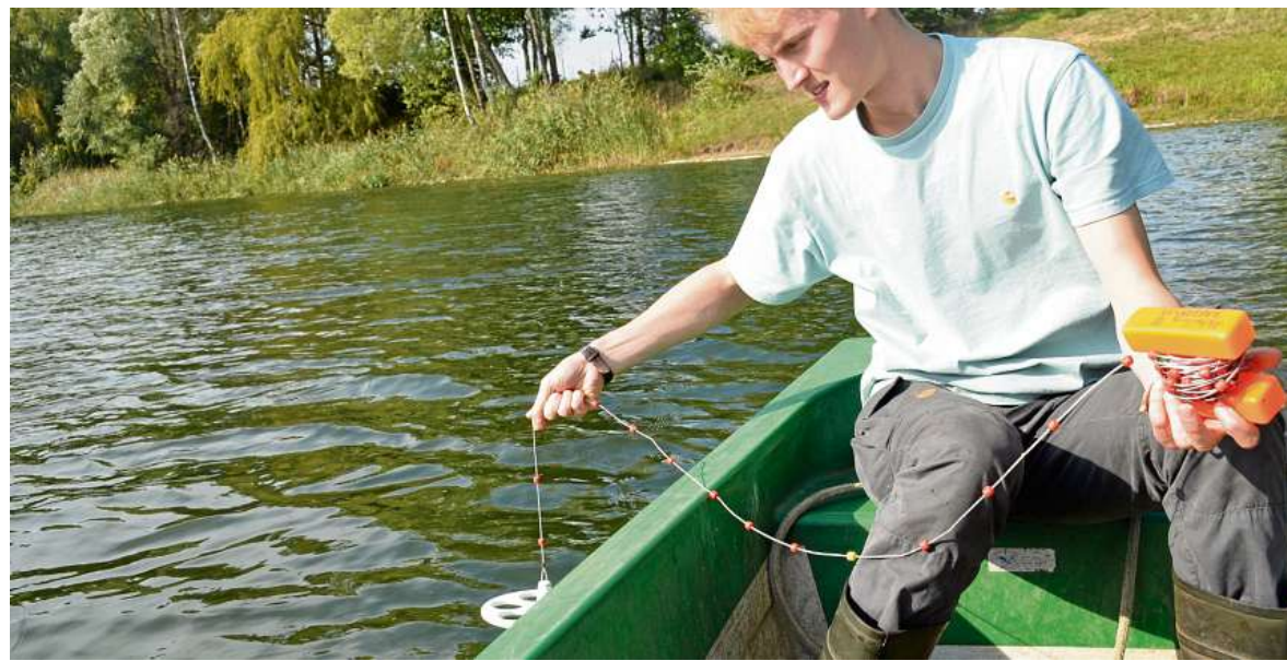
Fischen im Trüben? Die Sichttiefe des Sees gibt Informationen über das Algenwachstum. Student Jasper Münnich misst diese mit Hilfe einer speziellen weißen Scheibe.
